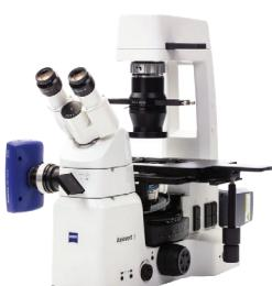
Инвертен флуоресцентен микроскоп ZEISS Axiovert 5
