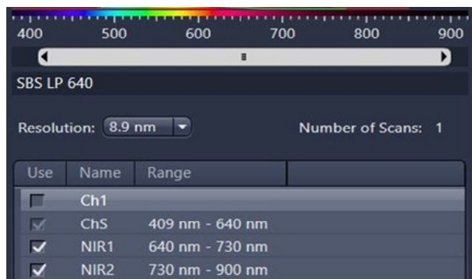
Фигура 9 Графичен потребителски интерфейс за спектрално откриване, интегриращ няколко типа детектори, които могат да се използват с LSM Plus.
